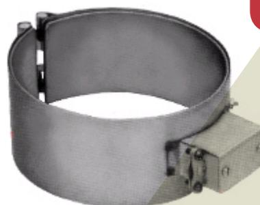
Posee caja de conexión con prensacable a  $180^\circ$  del tiraje. Los terminales se alojan en una bornera de porcelana (apta hasta 15 amp). Un Terminal lateral asegura la puesta a tierra del conjunto. Diámetro mínimo 70 mm. Ancho mínimo 50 mm.
