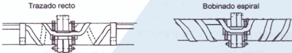
El cable debe ser bobinado cerca de la brida, para compensar la perdida de calor (no es necesario cuando la instalación del calefactor es recta y consiste en mas de un cable).
